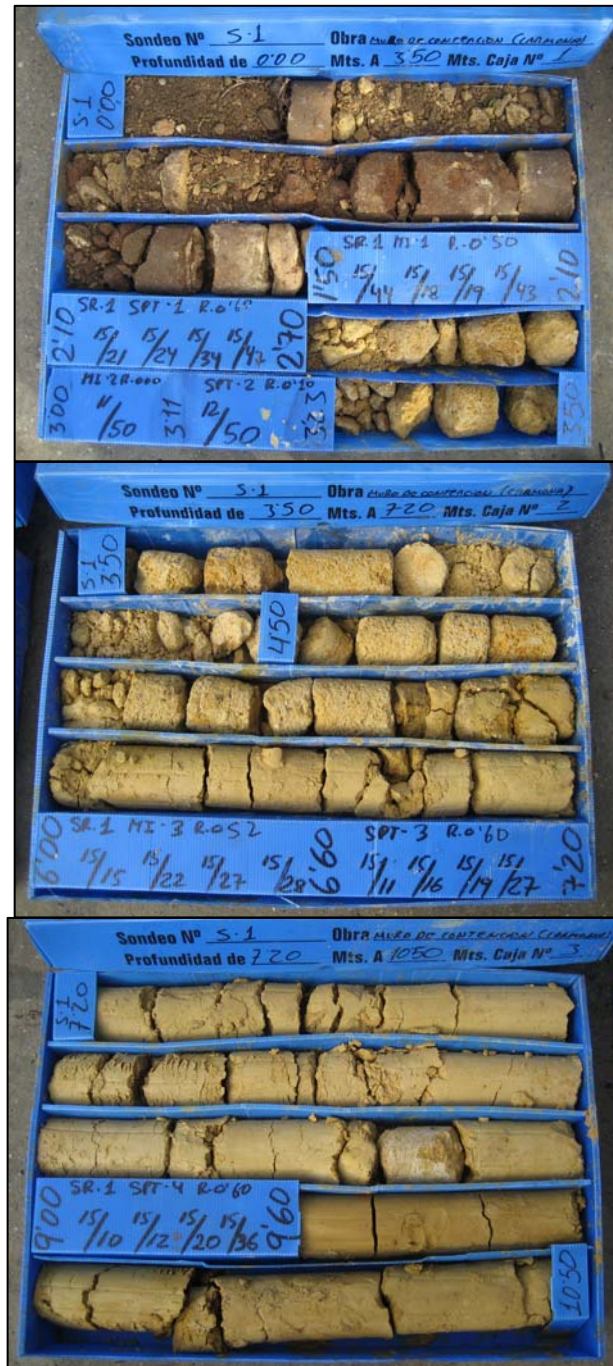
Sondeo 1. Muro de contención en escarpe para la futura continuación del vial en C/ Alcores, Carmona (Sevilla) EXCMO. AYUNTAMIENTO DE CARMONA
