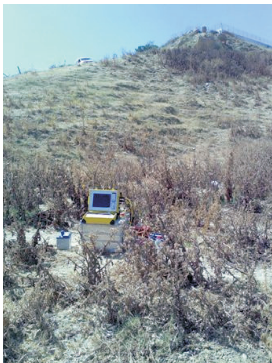
Foto 8.- Detalle del resistivímetro empleado y del inicio del perfil de tomografía eléctrica TME-2 .
