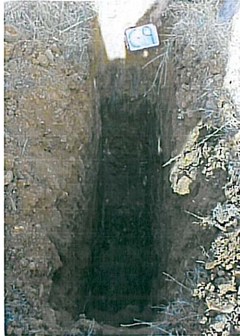
Figura 6. Calicata Mecánica
