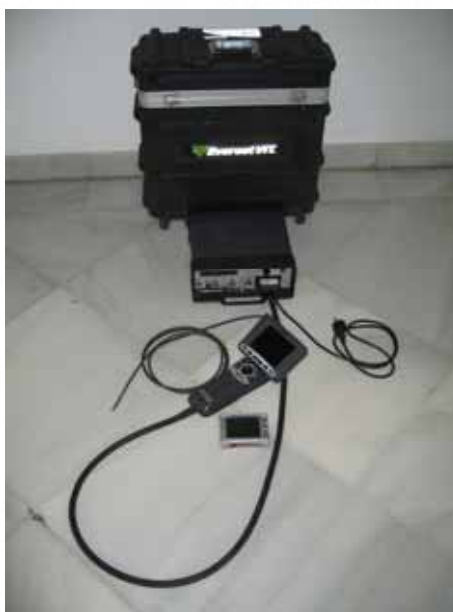
VIDEOSCOPIO MODELO XL PRO MEASUREMENT SYSTEM, CON SONDA DE 6 MM DE DIÁMETRO Y 2,5 M DE LONGITUD
